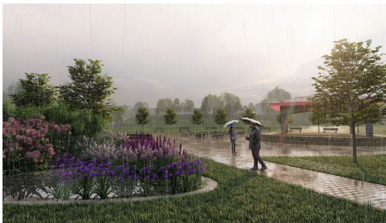
Wizualizacja ogrodu deszczowego w parku im. św. Jana Pawła II, który ma za zadanie zbierać wodę spływającą z utwardzonego placu i chodników, pozwalając na jej powolną infiltrację do gruntu i zapobiegając czasowym podtopieniom terenu zieleni | Wizualizacja Arbre Architektura Krajobrazu
